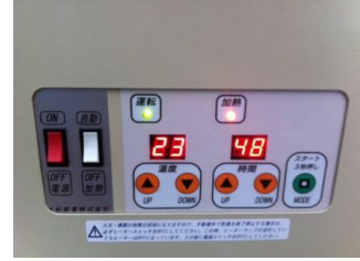
*電気式乾燥用機械(ディスプレイ部) 乾燥温度と時間の調整は、品種や乾燥粒数により異なります
